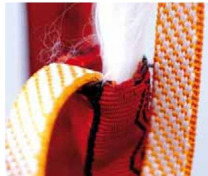
Los absorbedores de la serie Shockyard de Skylotec están patentados (carecen de bolsa de absorción que golpee o moleste). Más ligeros y fáciles de llevar. Cincha de Dyneema interna en caso de rotura. Frenada de caída progresiva y sin sobresaltos, ya que las fibras de poliéster se van abriendo poco a poco, amortiguando físicamente la caída. Este efecto es también psicológico ya que reduce el impacto emocional de la caída.
