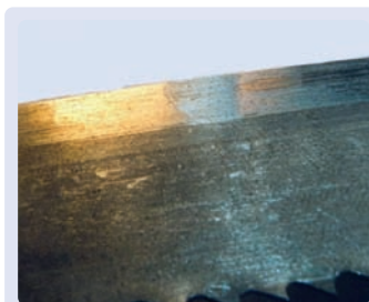
GRIETAS EMPEZANDO POR EL LOMO
