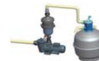
Detalle montaje filtro de arena
