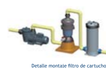
Detalle montaje filtro de cartucho
