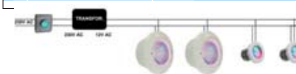
Esquema instalación luz blanca con pulsador
